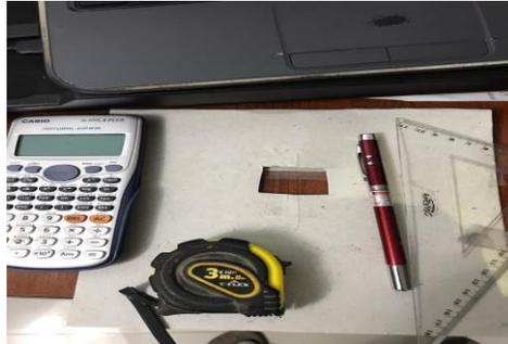
Figura 1. Recursos utilizados para experimento medida grosor de cabello.
